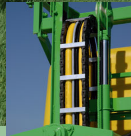
Zentrale Schlauchführung im Hubmast über eine Gliederkette
