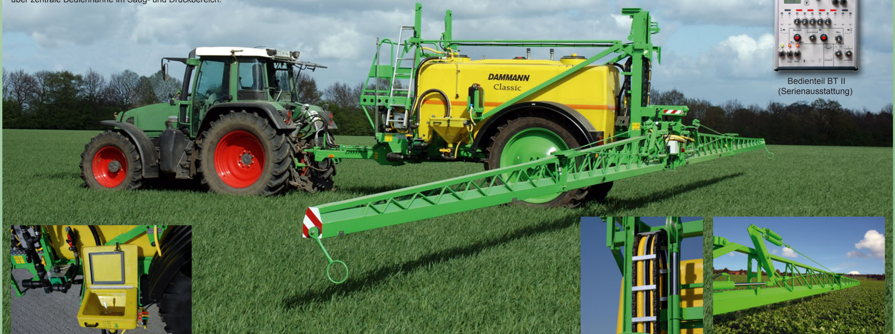
Mitteleinspülschleuse 60 l mit Kanisterspüldüse und Ringspüleleitung (rotierend)
