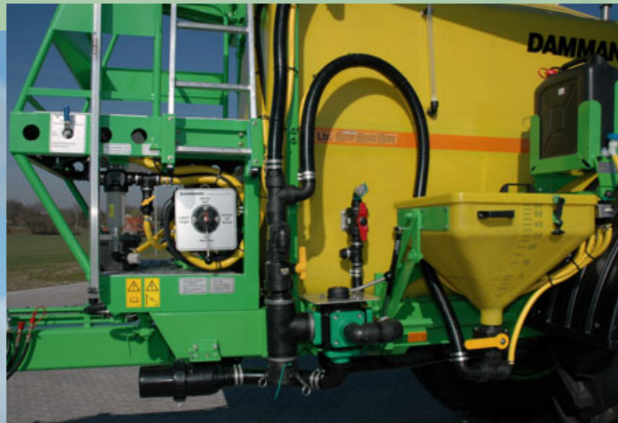
Übersichtliche Instrumente und Armaturen. Einfache Bedienung über zentrale Bedienthähne im Saug- und Druckbereich.
