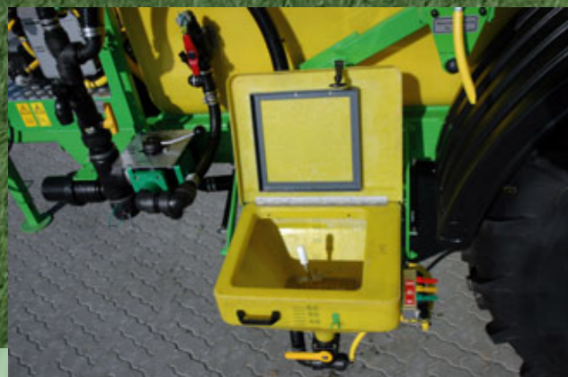
Mitteleinspülschleuse 60 l mit Kanisterspüldüse und Ringspüleleitung (rotierend)
