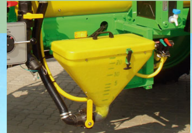
Einspülschleuse 30 l mit Injektor zum Saugen (400 l / min. Befüllleistung)
