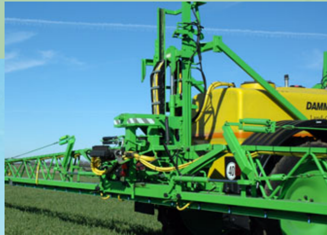
Gestängeaufhängung. Das Maß aller Dinge für höchste Stabilität und optimalste Gestängelage. Die Grundvoraussetzung für eine optimale Applikation.
