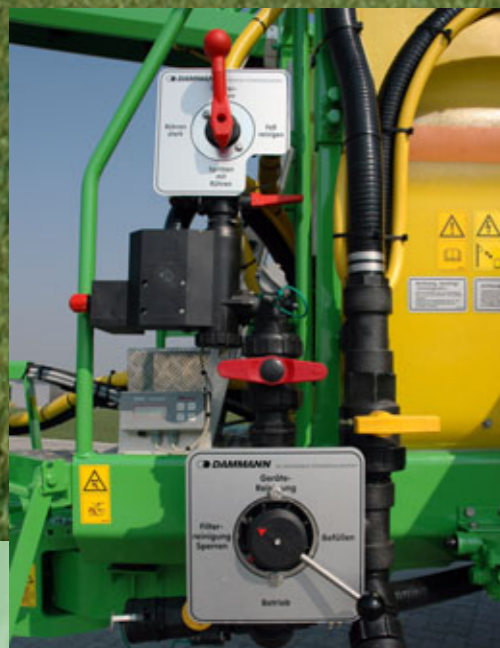
Einfache Bedienung über zentrale Bedienungshöhe im Saug- und Druckbereich
