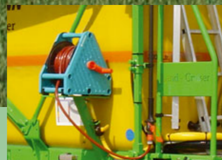
Waschbürste mit Schlauchaufroller (Sonderausstattung)
