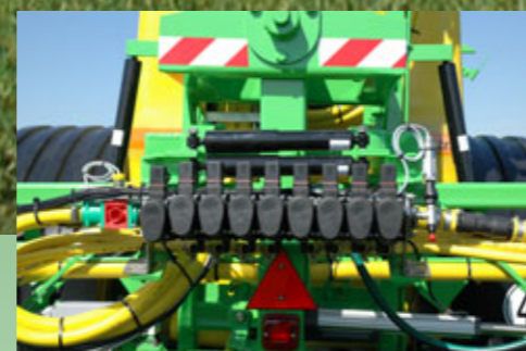
Hochwertige elektrische Teilbreitenarmatur
