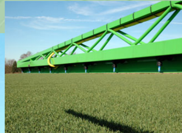
Spritzgestänge in stabiler Ausführung mit geschützten Düsen, hydraulisch geklappt
