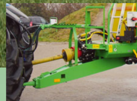
Starre Deichsel - Untenanhängung
