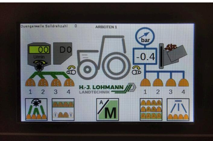
Der LOHMANN JUPITER ist serienmäßig mit der WieTaCon 8 Steuerung ausgestattet. Über diese werden sämtliche Funktionen sowohl vom Düngerstreuer als auch von der Pflanzenschutz-einheit angesteuert und überwacht. Im Automatikmodus werden Ausbringungsmenge, und Fahrgassenschaltung vollautomatisch über Signale von Pflanzmaschine und Hubwerk angesteuert. Die Dosierung erfolgt fahrgeschwindigkeitsabhängig.
