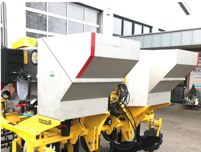
Serienmäßig ist der Frontdüngerstreuer von LOHMANN zur Montage der Pflanzenschutzzeinheit JUPITER B vorgerüstet. Dank der Vorrüstung kann diese jederzeit nachgerüstet werden. Mit der Einheit ist die Furchen- oder Knollenbehandlung direkt an der Pflanzmaschine möglich. Die Steuerung und Überwachung erfolgt über das WieTaCon 8 Terminal
